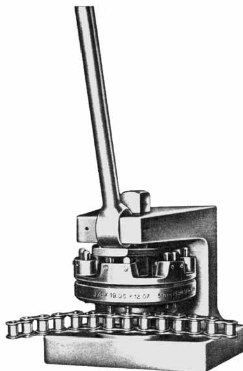
Smontacatene da banco tipo 3 per catene da 3/8" a 3/4"
